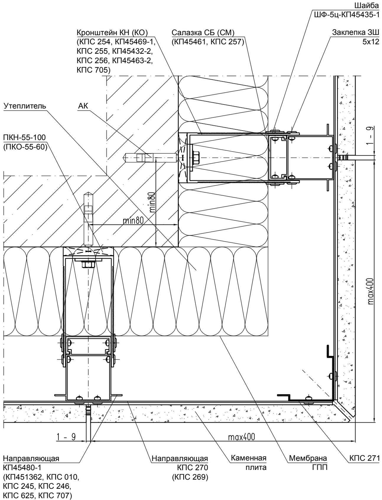
Кронштейны с разных сторон угла ставить с зазором 100 мм по высоте относительно друг друга.
