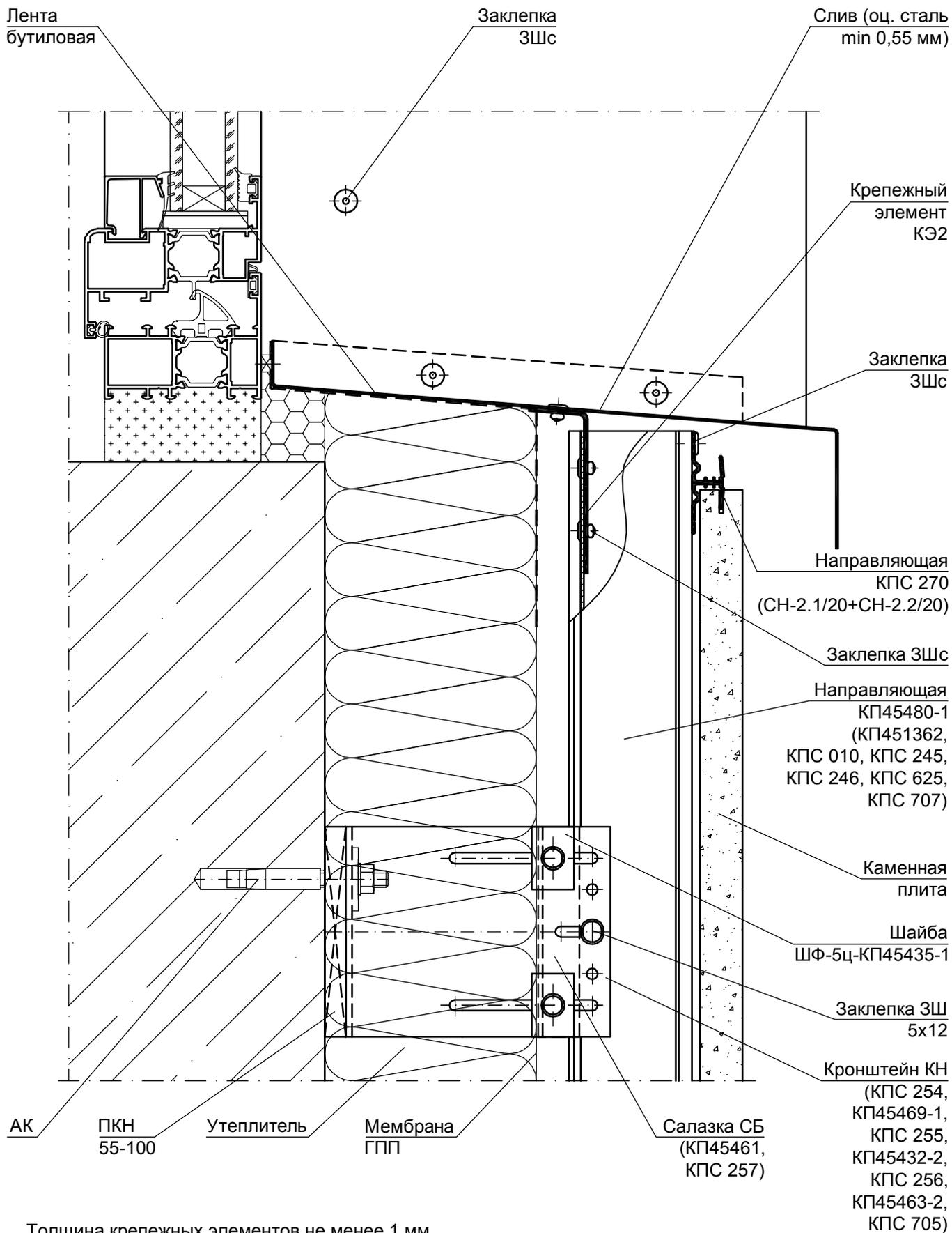
Толщина крепежных элементов не менее 1 мм.
