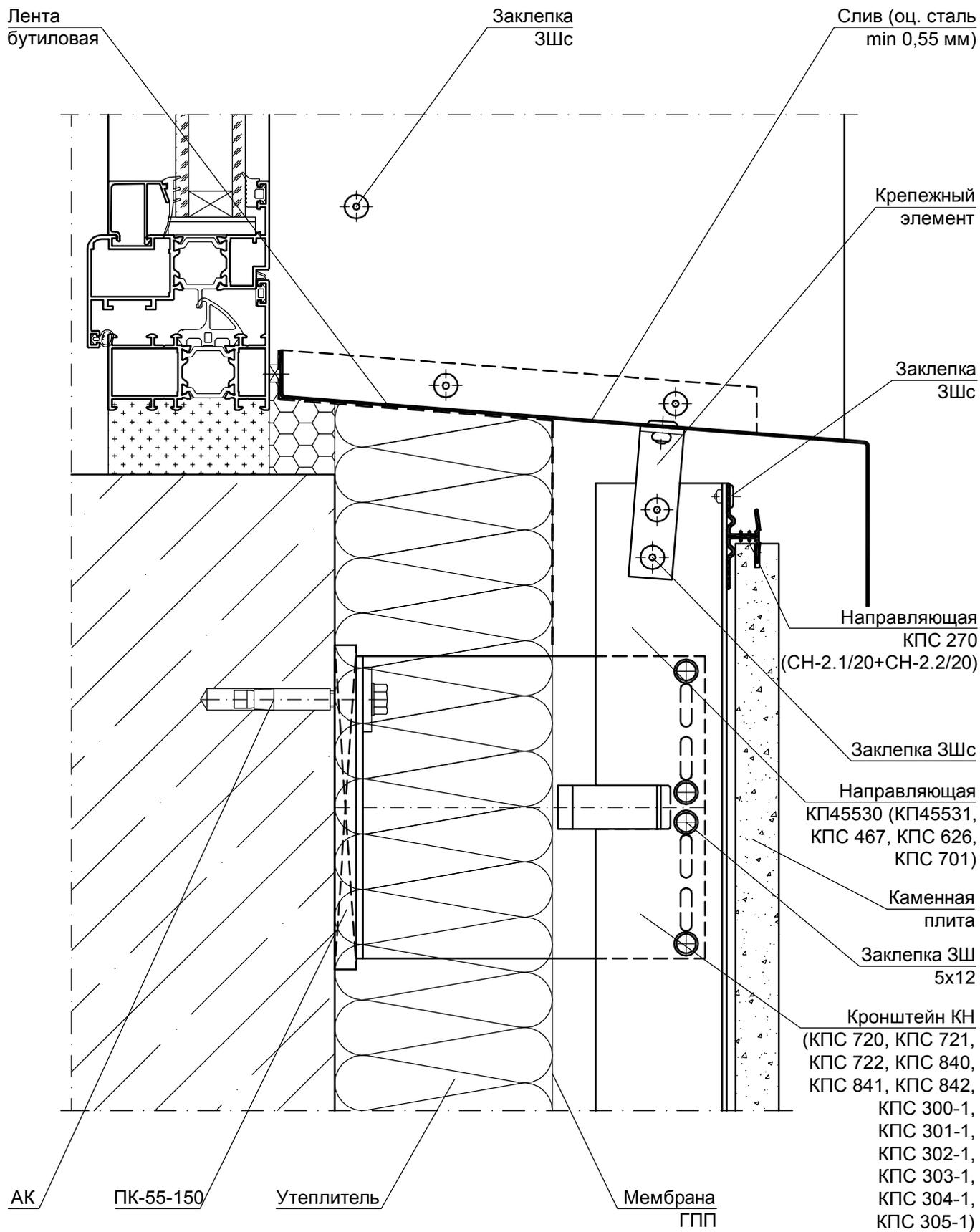
Толщина крепежных элементов не менее 1 мм.
